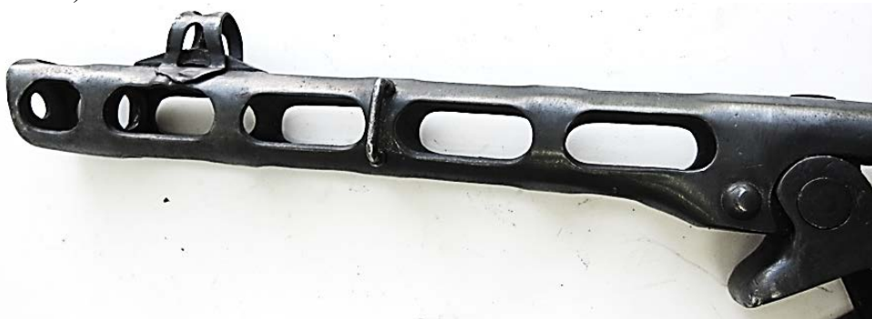
Иллюстрация 3 — Деактивированный вариант пистолета-пулемета Шпагина ППШ 41, в ствольной коробке, которого отсутствует ствол.
