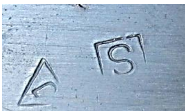
Иллюстрация 4 — увеличенное изображение клейма на внутренней поверхности ствольной коробки
