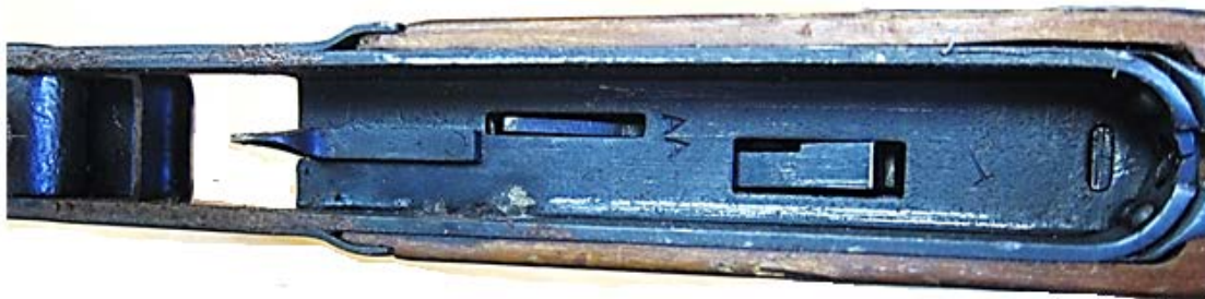
Иллюстрация 4 — Затворная коробка пистолета-пулемета Шпагина ППШ 41 с отсутствующими частями
