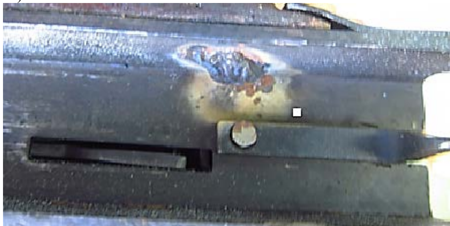
Иллюстрация 6 — Наплывы металла на левой стенке затворной коробки пистолета-пулемета системы Г.С. Шпагина.
