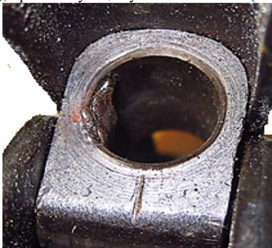
Иллюстрация 5 — Наплывы металла на вкладыше крепления ствола ствольной коробки с кожухом ствола пистолета-пулемета системы Шпагина Г.С.
